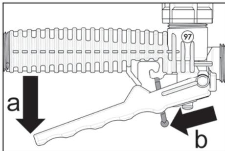
De sproeilans (10) kan in het handventiel (8) – na het losdraaien van de dopmoer – worden gedraaid. Dit is nuttig bij het bespuiten van de onderkant van bladeren.
