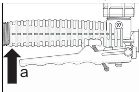
Het spuiten wordt onderbroken door het los te laten.
