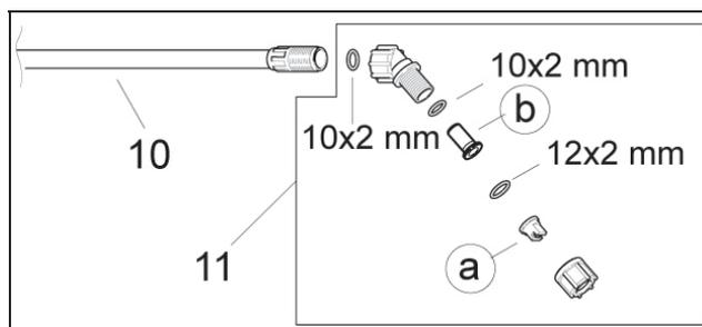
Schroef het sproeidopopzetstuk (11) met O-Ring (10x2 mm) handvast op de sproeilans. Geen gereedschap gebruiken!
