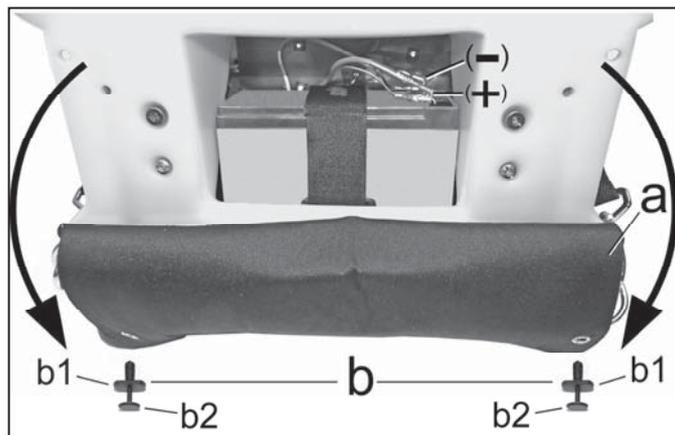
**Plus-pool:** Steek de rode kabelverbinding op het rood gemarkeerde contact van de accu.
