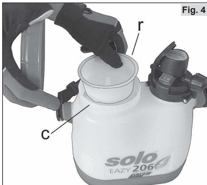
En el orificio de llenado (c) del tanque de aerosol está integrado un colador de llenado (r).
