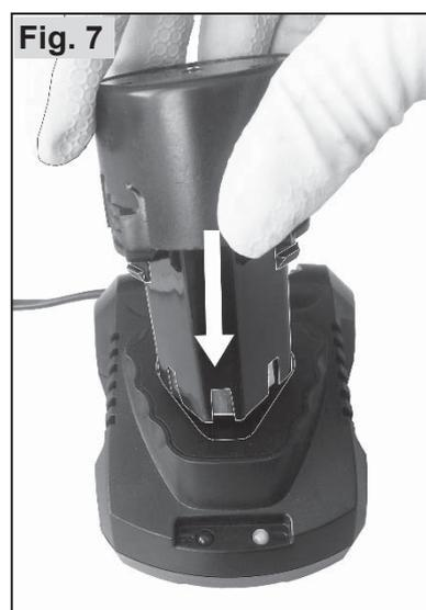
Inserte la batería en la posición correcta (como en la imagen) en el cargador.
