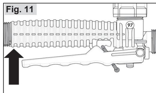
Para pulverizar, activar la válvula manual.
