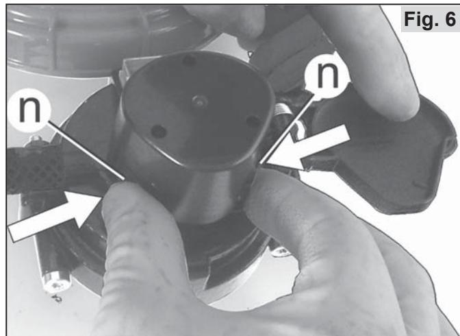
Para extraer la batería del dispositivo, presione las dos palancas de bloqueo (n) para desbloquear y retire la batería hacia arriba.
