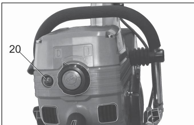
Im **Auslieferungszustand**, nach **längerer Ruhezeit** und wenn der Tank komplett "**leergefahren**" wurde befindet sich nach dem Tanken noch **kein Kraftstoff im Vergaser**.
