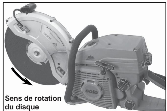
Le sens de rotation du disque est toujours celui indiqué ci-dessus par la flèche – indépendamment du fait de savoir si le dispositif de séparation est installé dans la position extérieure ou de moyenne.
