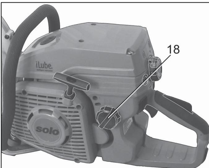
Les modèles 880-12 et 880-14 sont équipés d'un réservoir d'essence (18).
