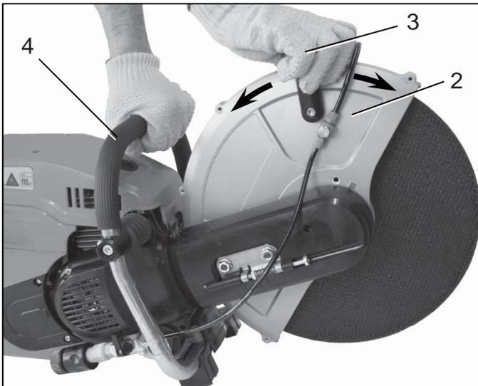
Le capot de protection (2) peut être pivoté en avant et/ou en l'arrière dans une certaine mesure.
