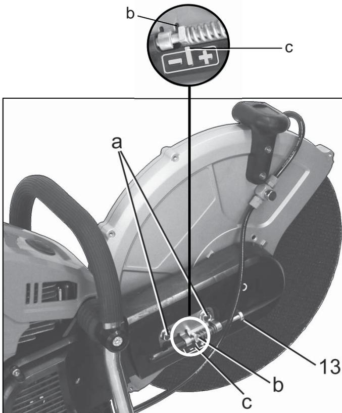
En principe, la tension de la courroie cannelée doit être ajustée correctement au démarrage de l'appareil à moteur. La tension doit absolument être vérifiée et ajustée lors de la première mise en service, après une remise en service après une période de non utilisation prolongée, après l'échange de la courroie cannelée ou après d'autres travaux de montage et la tension de la courroie cannelée doit éventuellement être corrigée.
