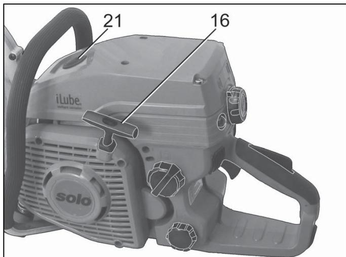
En actionnant la valve de décompression (21), une compression plus faible est obtenue dans la chambre de combustion du moteur. Ce qui signifie que le moteur oppose une force de résistance plus faible lors du démarrage ce qui facilite sensiblement le démarrage.
