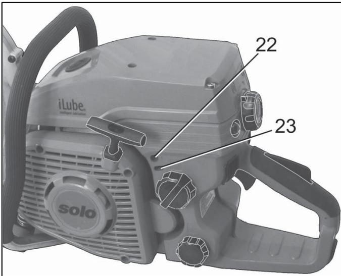
Avec un réglage correct du ralenti, le moteur devrait tourner sans à coups au ralenti, sans que le disque ne soit entraîné.
