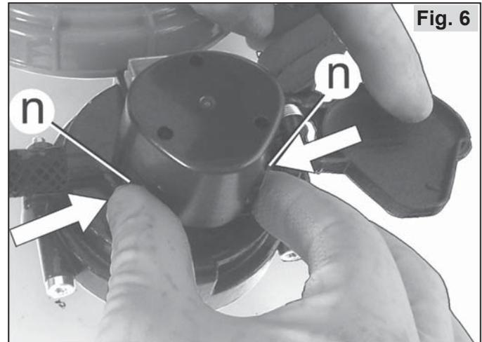
Pour retirer la batterie de l'appareil, appuyez sur les deux leviers de verrouillage (n) pour le déverrouiller et retirez la batterie vers le haut.
