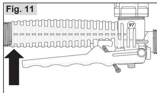
Pour pulvériser, actionner la soupape à main. La procédure de pulvérisation est interrompue en relâchant la soupape à main.
