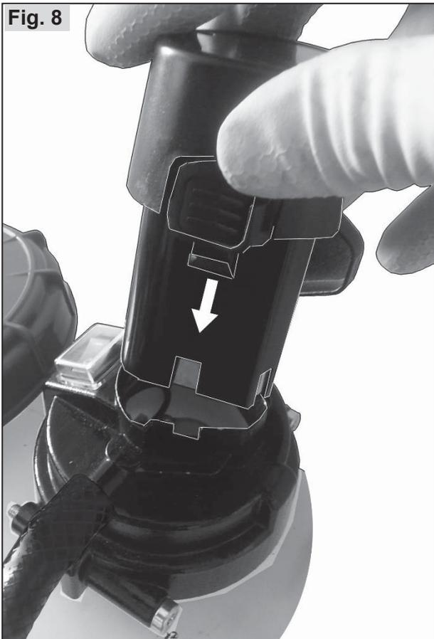
Insérez la batterie dans la position correcte (comme indiqué) de dessus dans le chargeur jusqu'à ce que vous le sentiez s'enclencher. Contrôler que la batterie est bien positionnée.
