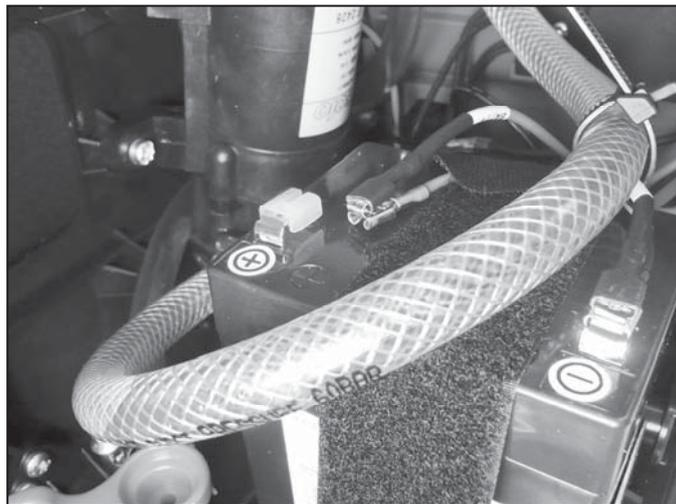
**Polo positivo:** Tire hacia abajo la tapa de seguridad de la conexión del polo positivo de la batería y conecte el enchufe del cable positivo firmemente en la conexión de la batería.
