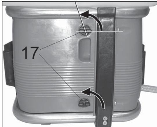
Para abrir la carcasa de seguridad gire los dos botones de cierre (17) unos 100° aprox. a izquierdas. Abra la carcasa de seguridad.
