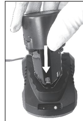
Den Akku in der richtigen Stellung (gemäß Abbildung) in das Ladegerät stecken. Die Leuchtdiode am Ladegerät leuchtet während des Ladevorgangs rot. Ist der Akku vollständig geladen leuchtet die Leuchtdiode grün. Blinkt die rote LED ist der Akku defekt.
